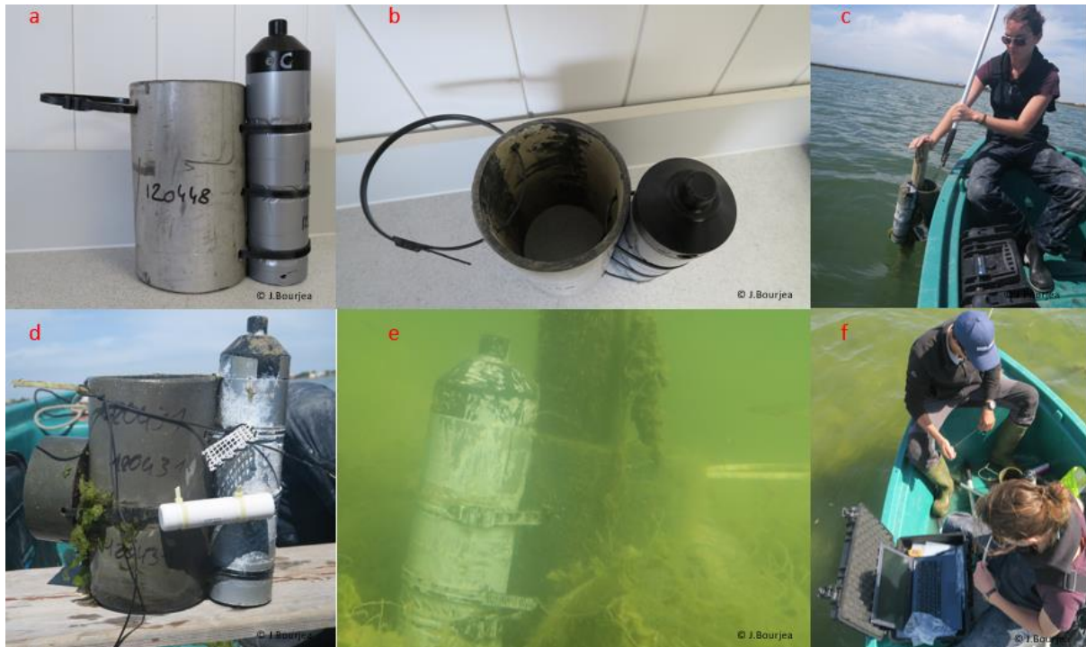
Figure 36 : Structure de fixation des hydrophones au sein du milieu ; a,b : Hydrophone fixé au pvc ; c : Mise à l'eau d'un hydrophone ; d : Hydrophone lesté avec sonde température ; e : Hydrophone dans le Prévost ; f : Téléchargement des données
